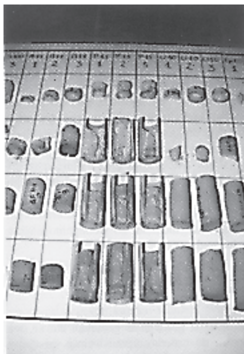
Afb. 5 Hardheidsmeting van de natuursteenproefstukken.
