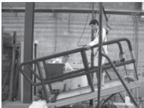
Afb. 1 In enkele laboratoria, zoals die van het CSTB (Frankrijk), wordt de slipweerstand bepaald met de methode van het hellend vlak.
