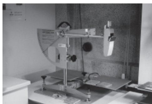
Afb. 2 Met de SRT-slinger wordt de slipweerstand bij voorkeur in het laboratorium bepaald, hoewel metingen in situ eveneens mogelijk zijn.
