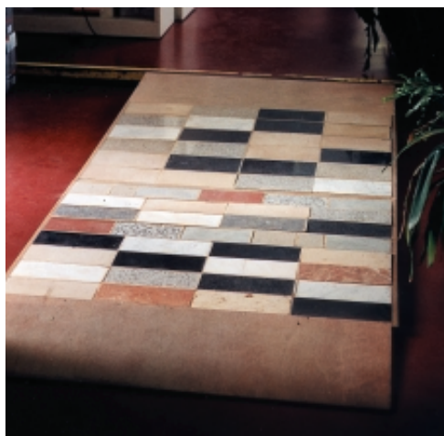
Afb. 7 Proefvloertje in het proefstation van het WTCB te Limelette, ter bepaling van de invloed van slijtage op de oppervlakte-toestand en de slipweerstand van verschillende tegelsoorten.
